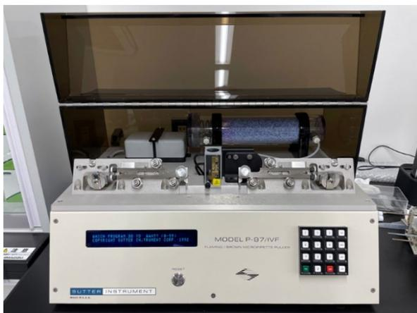
図 1 本研究で用いたフィラメント加熱式プラー (Sutter P-97/IVF)
