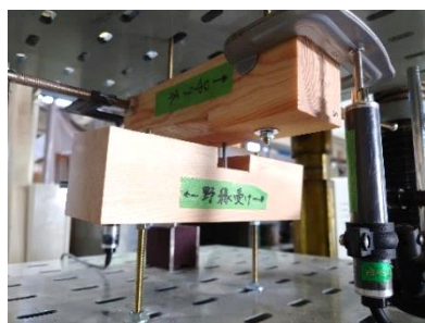
ii) 釘の引抜け破壊 a) B-C-X
