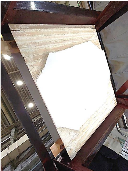
a) 出隅部 4 箇所から剥落 (順序 10: ナット緩め, 980gal, 9.5Hz)
