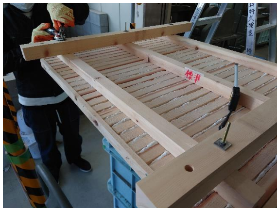
c) 野縁受け本材に交換後
