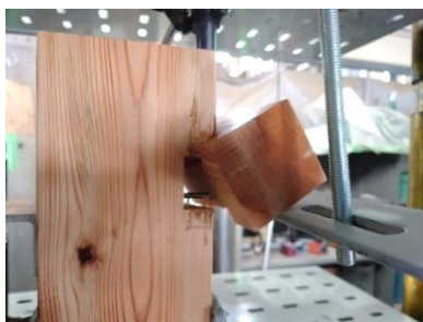
ii) 釘の引抜けと吊木の回転 b) A-B-Y
