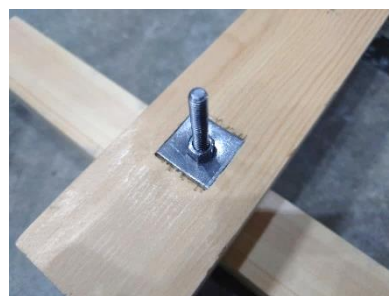
iii) 角ワッシャの歪み、野縁受けへのめり込み
