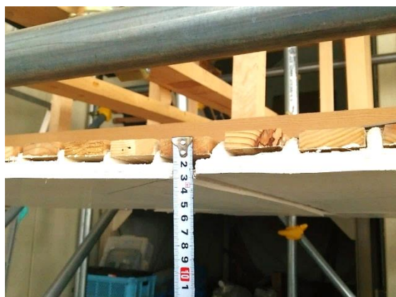
c) 目透かし幅の違いによる剥離幅の差異
