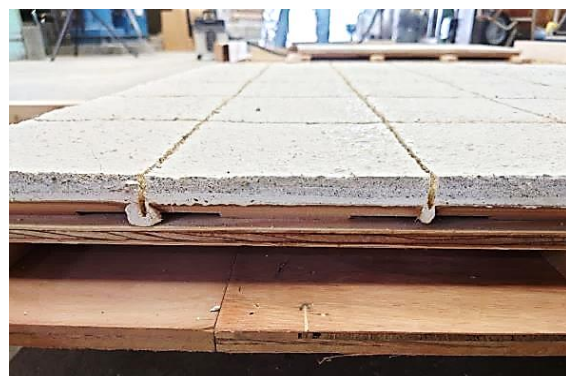
h) 親試験体小口からみた漆喰層の切断状態
