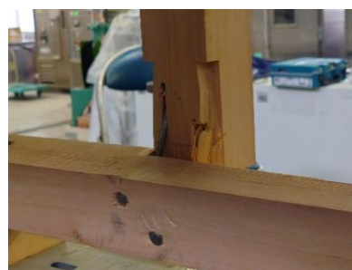
iii) 吊木ホゾの破壊状態
