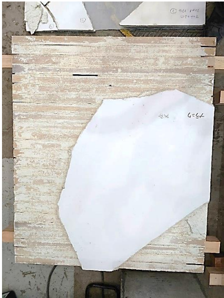
d) 最終加振後の剥落状態 漆喰引掛りの一部に脱落を認める
