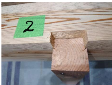
ii) 吊木側の支圧変形による 下方への滑り c) A-B-Z
