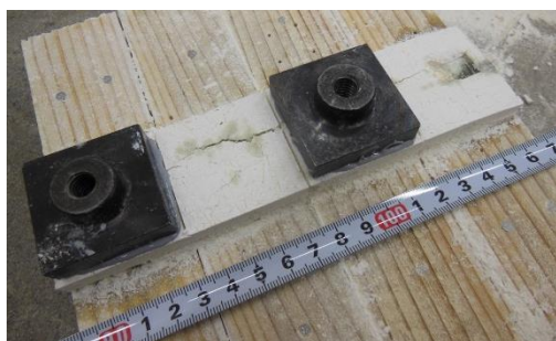
写真 3-3 フィラーアタッチメントの取付状況
