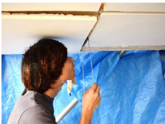
a) 剥離幅の測定 1
