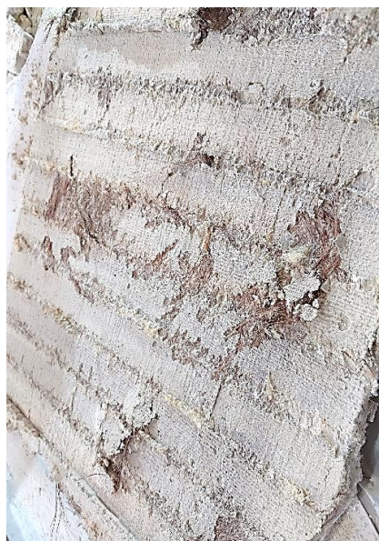
g) 剥落片の木摺り下地界面側 目透かし部の漆喰は破断型の痕跡が多く、テーパ一断面の木摺り下地による脱着抑制を確認
