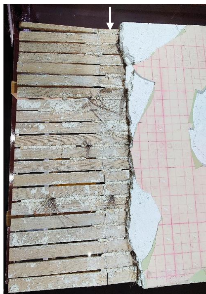
h) 剥落部の木摺り下地 矢印部に野縁が走り、目透かし部に残存する漆喰が少ないのは剥落後の加振で脱落した模様
