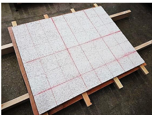
g) 要素試験体への分離準備（墨出し状態）
