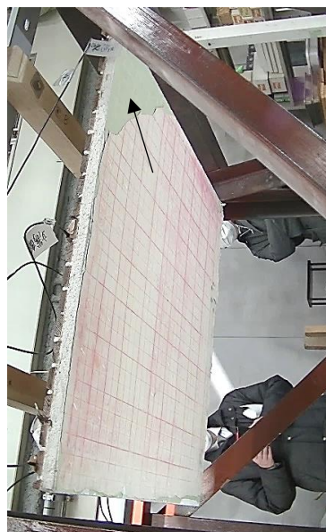
d) 試験前 (1 カメ) 矢印は 6.3.6(2.1) で記載した塗膜が剥離しかかっていた部分で、振動試験前に予め除去した
