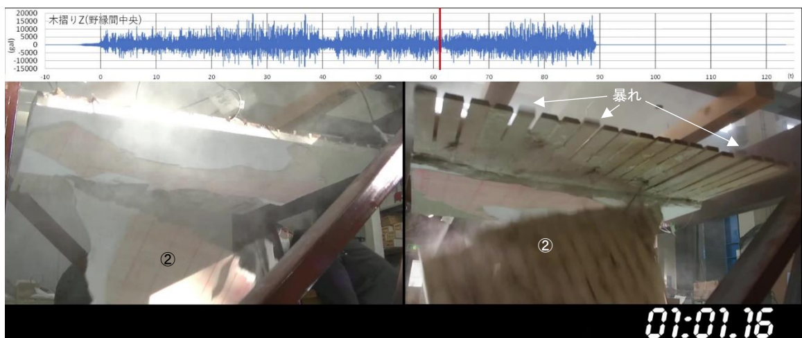
5) ②の落下と小幅板継手部分の暴れ
