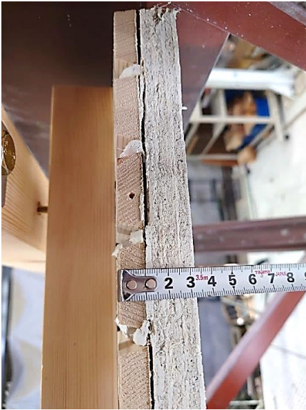
b) 木摺り漆喰界面浮きの進展 (順序12: ナット緩め, 980gal, 9.7Hz, 2回目)
