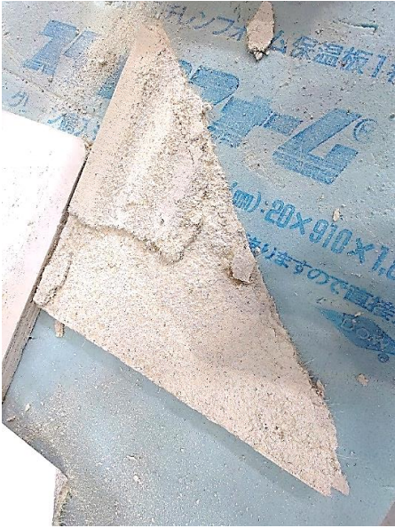
c) 層間剥離片 (下塗り～斑直し) (順序 10: ナット緩め, 980gal, 9.5Hz)
