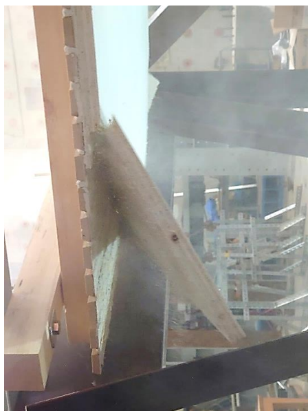
a) ②の剥落時 (順序 10 : ナット緩め, 980gal, 9.5Hz, 1 回目)
