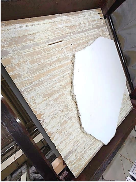
c) 出隅4箇所から剥落、内側へ進展 (順序13: ナット緩め, 980gal, 9.7Hz, 3回目)
