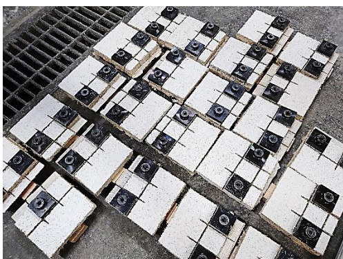
k) 引張試験アタッチメントの装着
