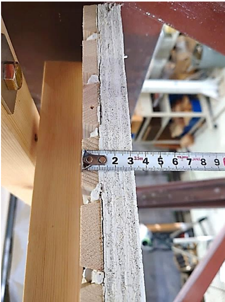
a) 木摺り漆喰界面浮き (順序10: ナット緩め, 980gal, 9.7Hz, 1回目)
