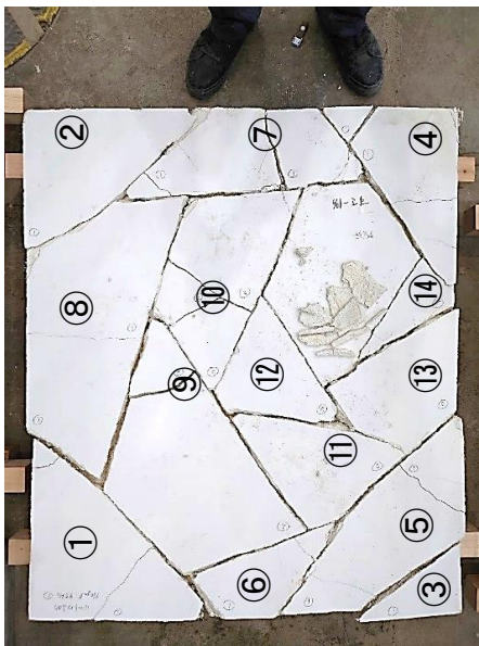
e) 剥落破片復元状態 破片が細かく、スサ量の少なさが影響したと 考えられる 写真 8-9 試験体の破壊性状 (漆喰強度抑制条件)
