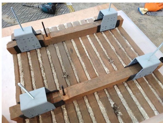
c) 野縁～野縁受け接合部は4箇所/1体
