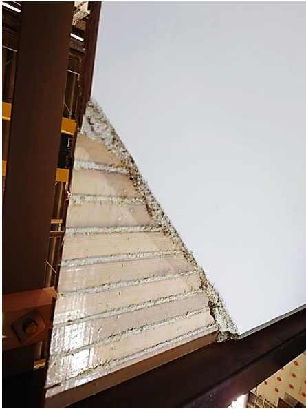
b) 出隅部の剥落 (順序 13 : ナット緩め, 980gal, 9.5Hz, 1 回目)
