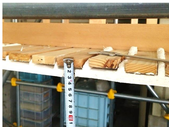
d) 引掛り量の違いによる剥離幅の差異
