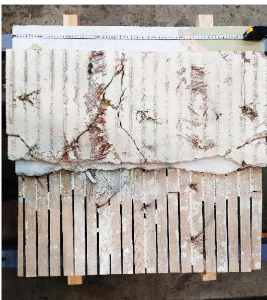
h) 剥落部の木摺り下地 矢印部に野縁が走り、目透かし部に残存する漆喰が少ないのは剥落後の加振で脱落した模様
