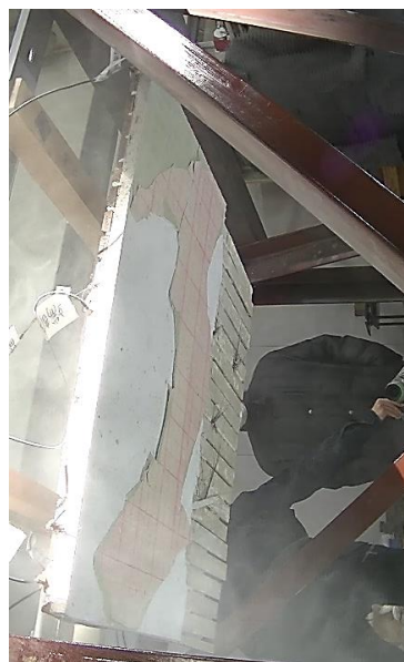
f) 漆喰全層の剥落状態 (1 カメ) (順序 12: ナット緩め, 980gal, 9Hz, 3 回目)
