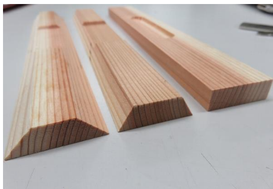
a) 所定の断面に加工された小幅板
