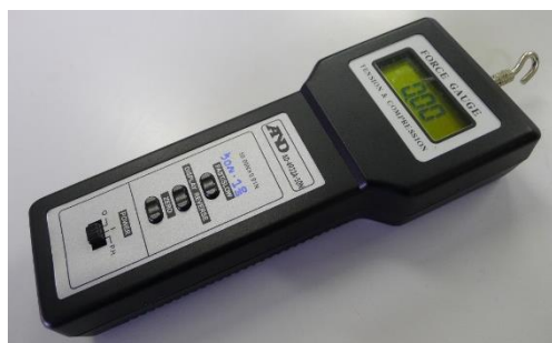
写真 3-4 付着強さ試験に用いた試験機
