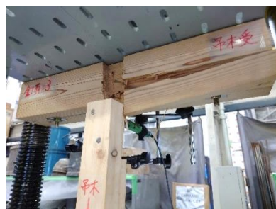
iii) 吊木受けの割裂破壊 (3体目のみ)
