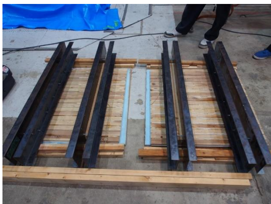
a) 溝形鋼材の圧着による野縁の固定
