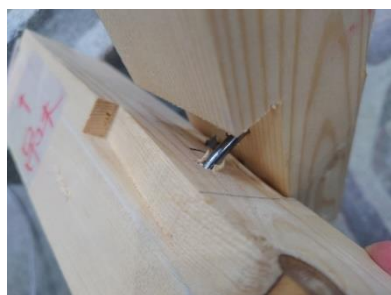
ii) 釘の引抜け破壊 b) B-C-Y
