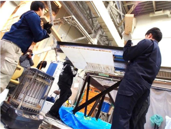
c) 加振治具への吊り下げ
