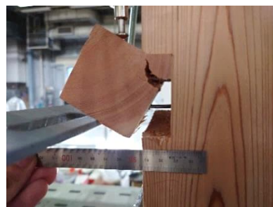
iii) 釘の引抜けと吊木の割れ
