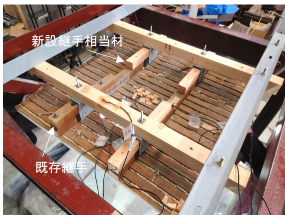
e) 野縁受けとの接合状態 (AMS-4) (継手材が付帯するため、金物はそれを跨ぐように取り付け、継手材が無い3カ所にも相当材を新設)
