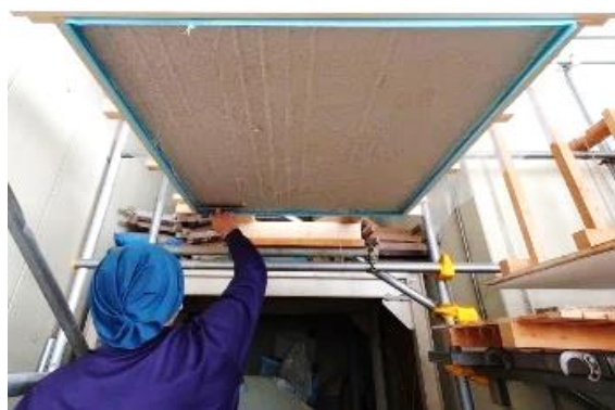
f) 天井面を想定した漆喰塗り（下塗り工程）
