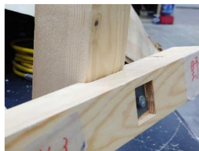
iii) 相欠き部のめり込み
