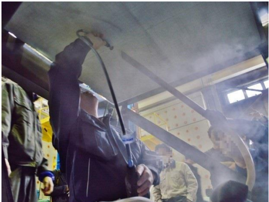
a) 切欠き作業 b) 試験体に入れられた切欠き（矢印部分） 写真 3-10 実試験体への切欠き作業の様子
