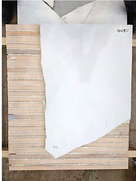
d) 最終加振後の剥落状態 漆喰充填度の低い端部を除き、漆喰引掛り部の脱落は認められない
