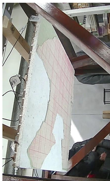
e) 漆喰上塗層の一部剥落状態 (1 カメ) (順序 10: ナット緩め, 980gal, 9Hz, 1 回目)
