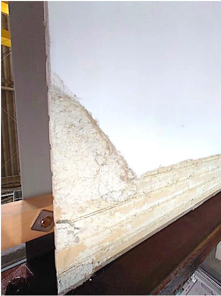
b) 層間剥離 (下塗り～斑直し) (順序 10: ナット緩め, 980gal, 9.5Hz)
