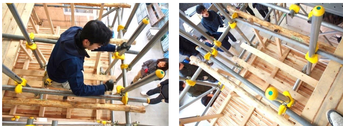
写真 3-16 実大試験体を用いた吊り足場の運用試験
