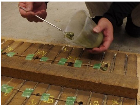
e) IV : 充填材による穴埋め
