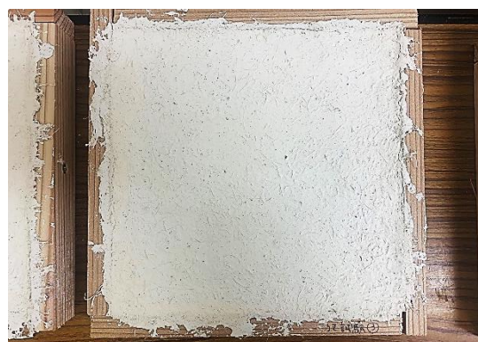
b) 漆喰施工後（側枠残存状態）
