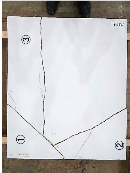
e) 剥落破片復元状態 付着が作用しない場合、面の抵抗が少なくなり、破片サイズが大きくなると考えられる
