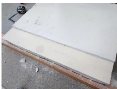
e) ボード除去状況 接着剤塗布部以外の塗膜は健全状態を維持
