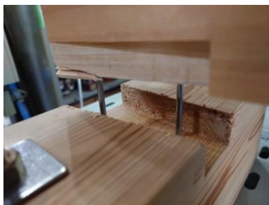
ii) 釘の引抜け状態 a) A-B-X
