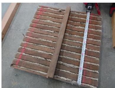
a) 野縁位置、漆喰状態を確認し、試験対象部分を策定
