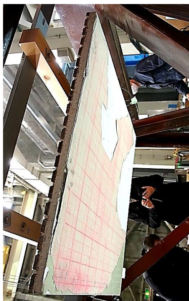
b) 漆喰上塗層の一部剥落状態 (2 カメ) (順序 10: ナット緩め, 980gal, 9Hz, 1 回目) 肌別れ表面 (中塗層) が平滑な仕上がりとなっている影響により上塗りとの付着が脆弱になっていた可能性あり
