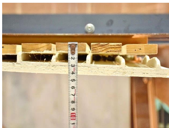
b) 加振前の N1-C 領域の剥離(無補修部分)
