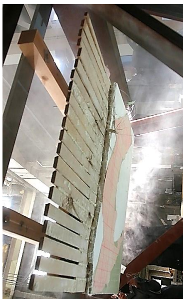
c) 漆喰全層の剥落状態 (2 カメ) (順序 12: ナット緩め, 980gal, 9Hz, 3 回目) 野縁より外側、木摺り下地片持ち部分が剥落した。小幅度 3~4 枚おきに継手を認める
