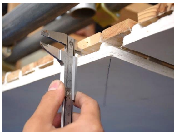
b) 剥離幅の測定 2
