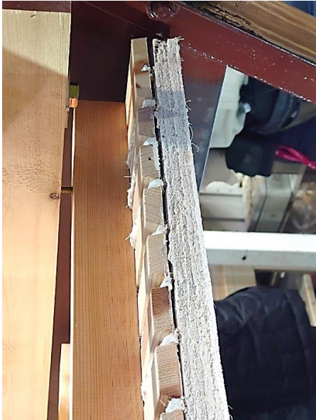
a) 木摺り漆喰界面浮き (順序 13 : ナット緩め, 980gal, 9.5Hz, 1 回目)
