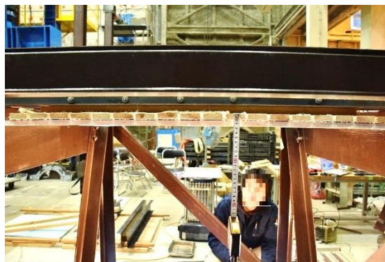
d) 加振前の N1-2 断面(全面補修)
