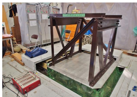
b) 設計図を基に鋼材で作製した加振治具
