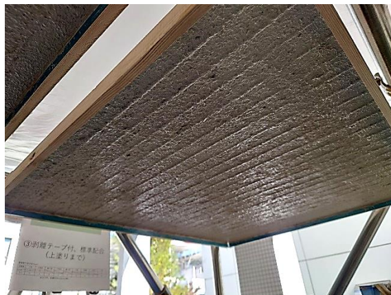
b) 下塗り施工後の目透かしに沿った漆喰の垂れ (不具合ではない)
