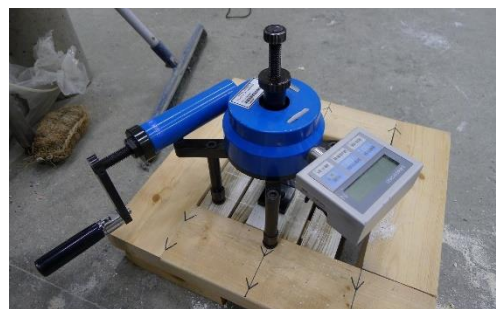
写真 3-6 補修試験体の強さ試験に用いた試験機
