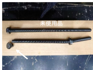
iii) ボルト破断の状態 (野縁側のワッシャ付近)
