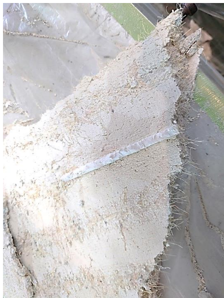
c) ⑫の漆喰引掛り部の脱落 (順序 10 : ナット緩め, 980gal, 9.5Hz, 1 回目)
