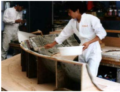
図 6.94 補強に新聞紙の張り付ける。
