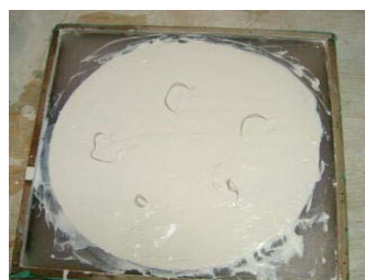
図 6.89 石膏が多少硬化した時点で空気を追い出すために、型を軽く揺すったり、叩いてみる。脱型は水中で行うとよい。脱型しやすいように針金を付ける。
