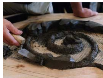
図 6.25 留めさらい鍍での成型・金鍍押さえ
