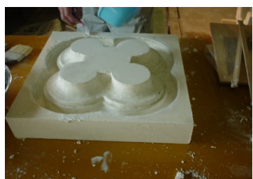
図 6.42 シリコンによる母型作成
