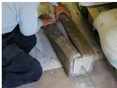
図 4.40 母型にグラウト材料を流しこみ複製を作り、その脱型している状態。
