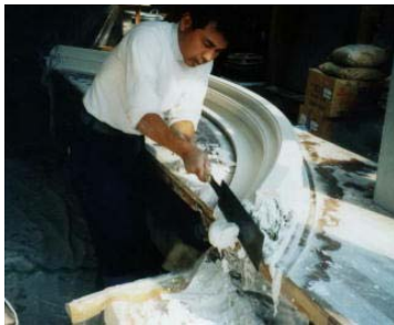
図 6.97 寸法合わせて採寸し、切断する。
