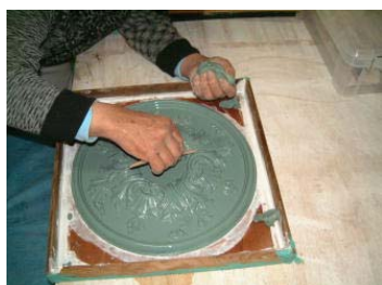
図 6.85 粘土または油土で原型を作製
