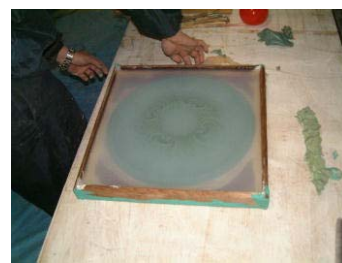
図 6.87 寒天が流れないように枠に、目塗りをしておく。母型を丁寧に脱型する。
