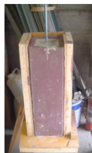
図 4.39 原型を仮枠に取付け、ウレタン樹脂を流し込んで母型を作成する。
