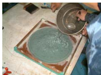
図 6.86 寒天を母型に流し込む。寒天は固めにする
