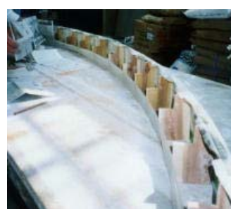
図 6.93 合板の型の作成
