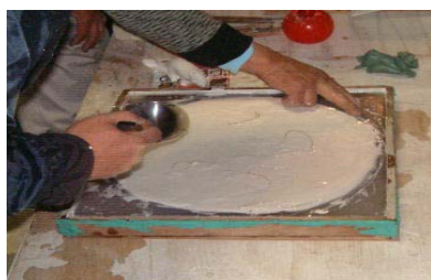
図 6.88 石膏の流し込み。石膏は最初やわらかいが、序々にクリーム状となり、多少指あとができるくらいに流し込む。
