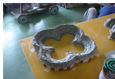
図 6.41 粘土による原型制作
