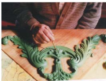
図 6.81 油粘土で母型作成
