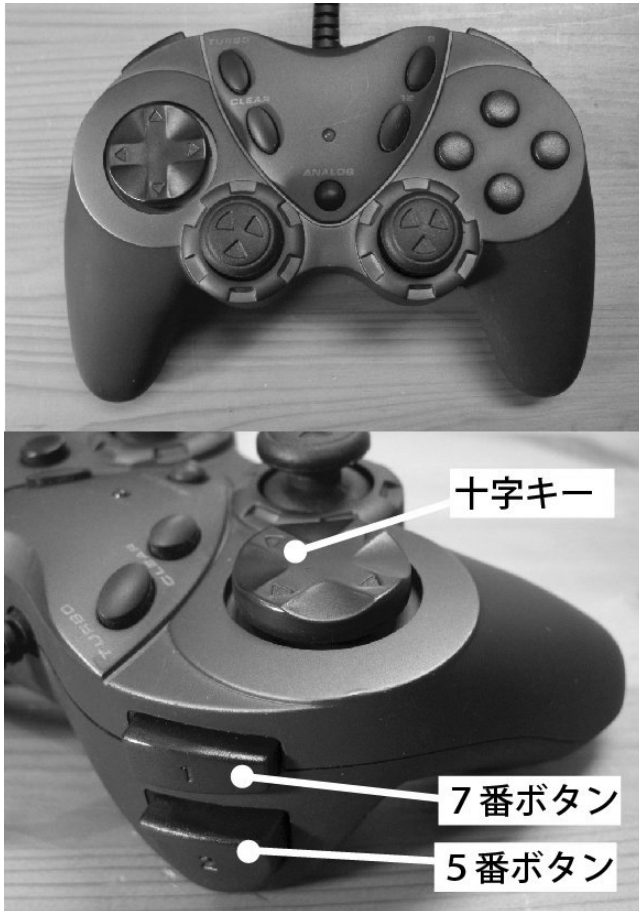
図 2.2 ゲームパッドの外観（上）と左側のボタン群（下） Figure 2.2 Above: Gaming Pad, Below: Buttons at left
