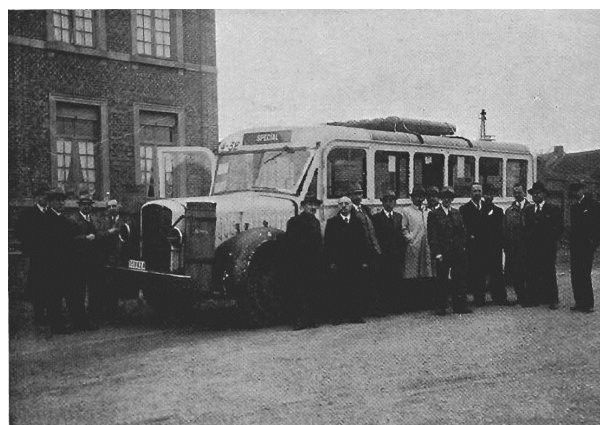
図5 アンモニア・石炭ガス燃料バス（ベルギー）1943 年 4 月
