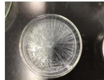
**考察** 実験1では結晶の先端部の形状を観察することはできなかったが、結晶の細かさに違いが見られる部分があった。過冷却度が**大きい**50°Cのものの方が結晶構造が**細か**かったため結晶構造が細かい方が熱放出に有利なのではないかと考えた。しかし実験2より結晶構造は冷却時の振動などによって変化することが分かったため実験1における過冷却解消までの溶液の扱いを一定にする必要がある。先端部の構造を観察するためにより大きいシャーレを用いる。
