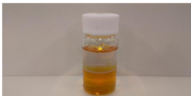
写真1 ヘキサンを用いた抽出（混合前）
