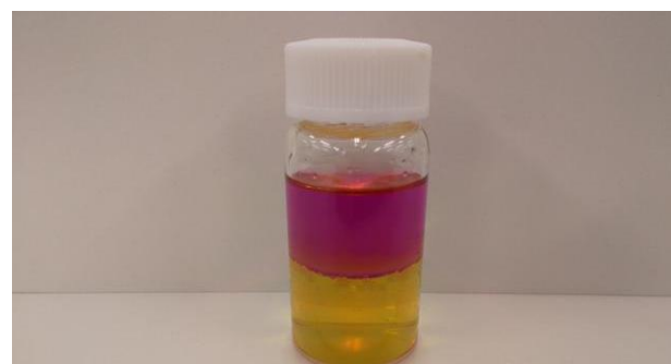
写真2 ヘキサンを用いた抽出（混合後）
